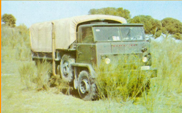
Prototipo del Panther II con su primera cabina. Nótese tras esta la rueda de repuesto lateral elevada.
