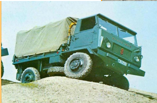
Prototipo del Panther II con su primera cabina. Nótese tras esta la rueda de repuesto lateral elevada.
