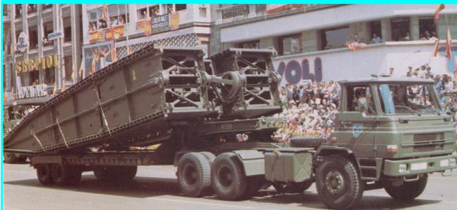
Un Barreiros 3464, cabeza tractora 6x4, arrastrando un remolque con puente de tijera de carro lanzador AVLB M60, tarea en la que está reemplazando a la cabeza tractora M-123A1C, de tracción 6x6, una sustitución muy desventajosa, en nuestra opinión.
