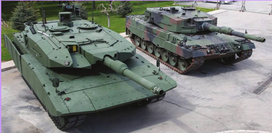
Ilustrativa comparación entre un Leopard 2A4 (a la derecha) y su remodelación turca Leopard 2T , basada en el concepto Leopard Revolution
